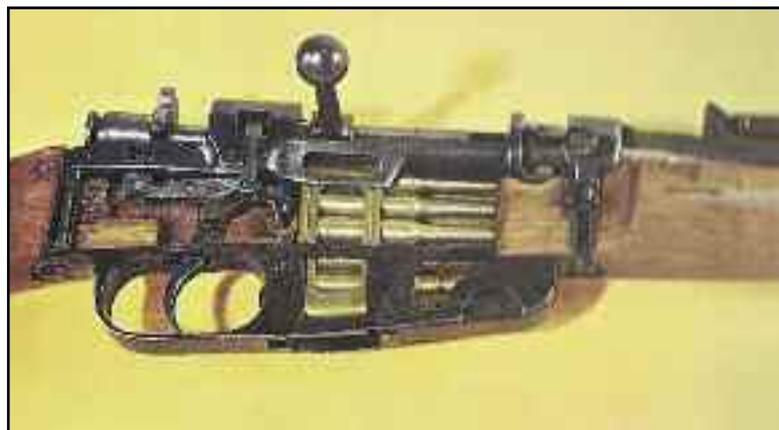
Caric spaccato 91: Spaccato del sistema di alimentazione in cui si nota l'apertura in basso del serbatoio
