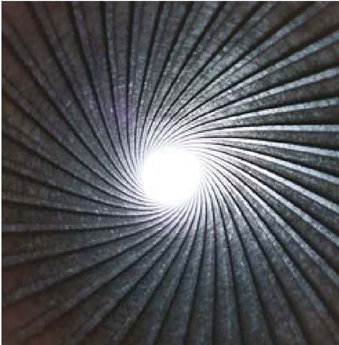
Rigatura interna alla canna di un cannone
