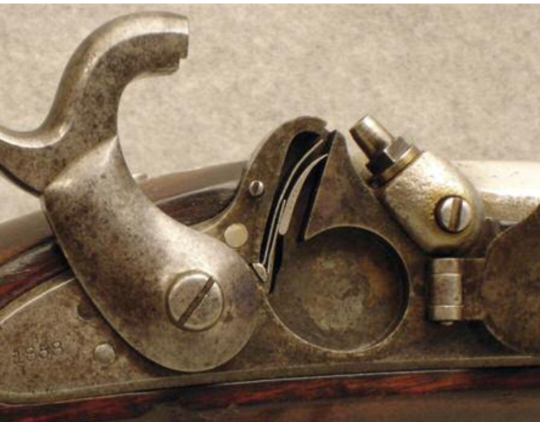
Particolare del meccanismo a percussione, con cane armato, senza capsula
