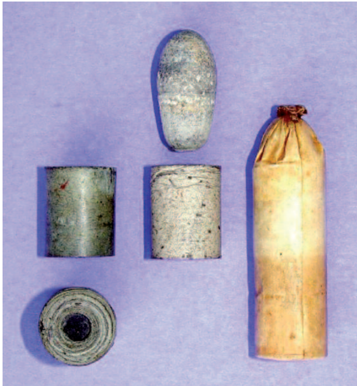
La cartuccia inventata da von Dreyse, con capsula fulminante inserita sotto la pallottola e bossolo di carta
