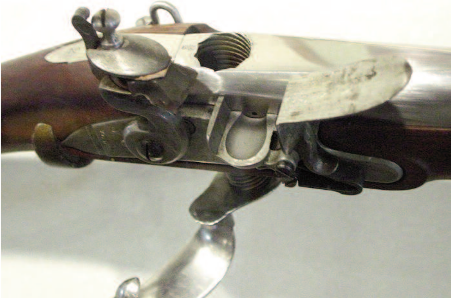
Qui sopra: Fucile sistema Ferguson: ben visibile sopra la culatta il foro lasciato aperto dal vitone
