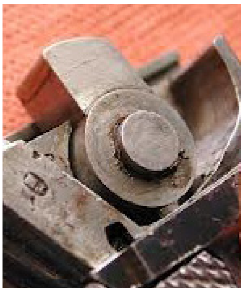
Il blocco rotante impernato su un solo lato della Glisenti mod. 1910
